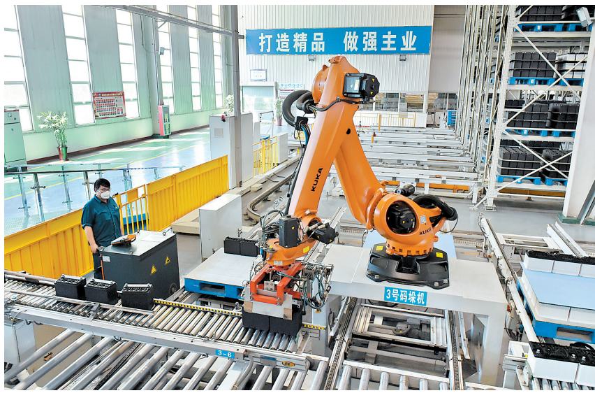
近日,在位于保定市徐水区的中船重工风帆有限责任公司产业园装配车间,机械手在对蓄电池进行装配入库。 记者 史晟全摄
