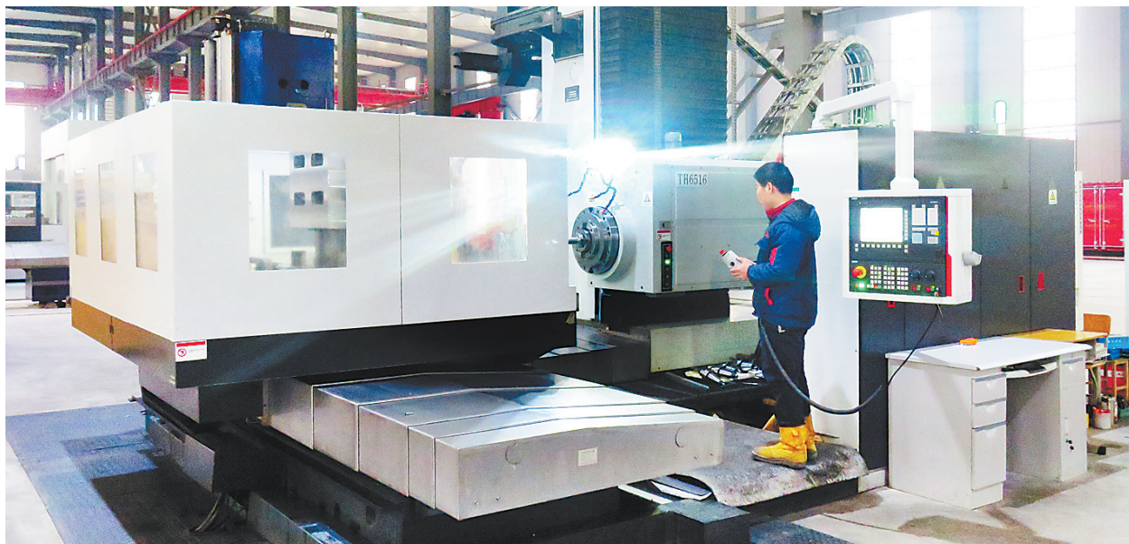
日前，博路天宝公司技术工人正在操作数控机床对防喷器配件进行精密加工。 通讯员 鲁敏 霍笑楠摄
