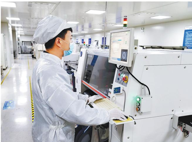
在鹏远光电的SMT车间,员工正在进行线路板贴片工序。
