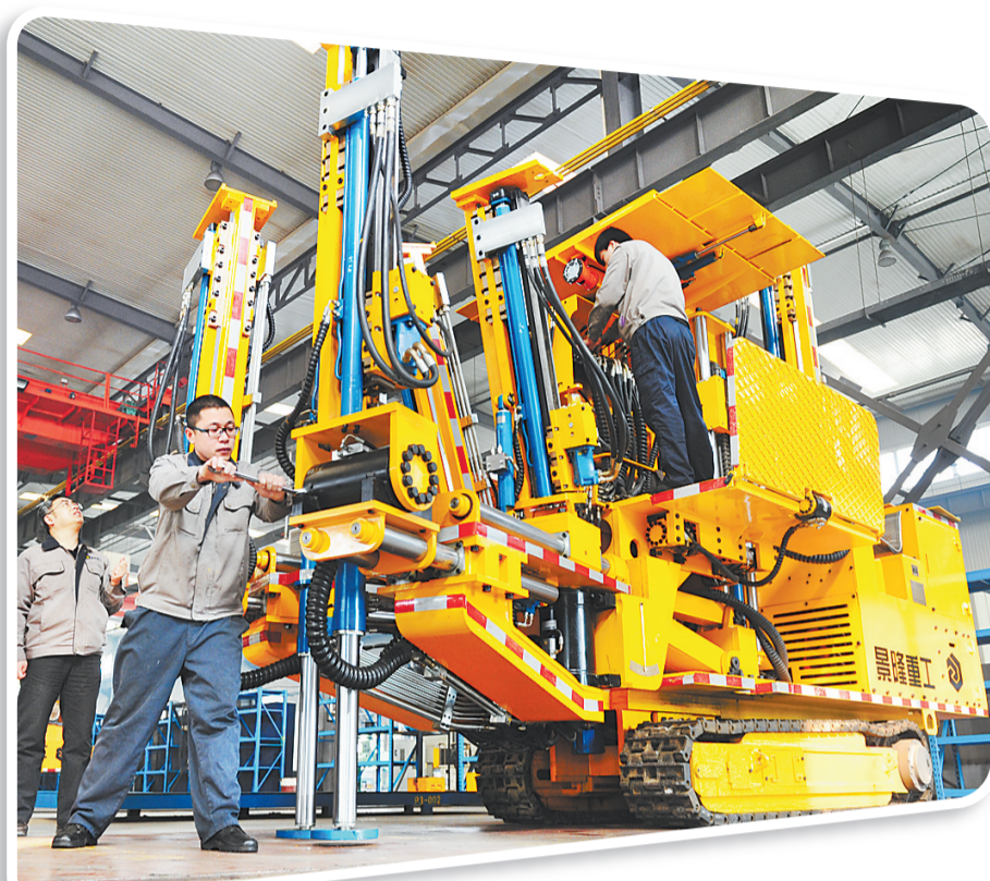
近日,景隆重工机械有限公司技术人员正在调试创新研发的业内首款六臂全液压锚杆锚索钻机。该公司的锚杆钻机在细分行业细分市场占有率达到60%,行业排名全国第一。
