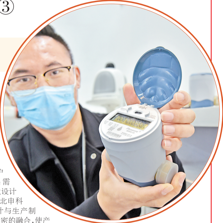
10月17日,在第四届河北国际工业设计周河北工业设计成果展区,工作人员展示全新设计的智能超声波水表。 河北日报记者 赵海江摄
