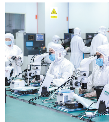
河北圣昊光电科技有限公司的技术人员在对芯片进行人工镜检作业。河北日报通讯员 杨木摄
