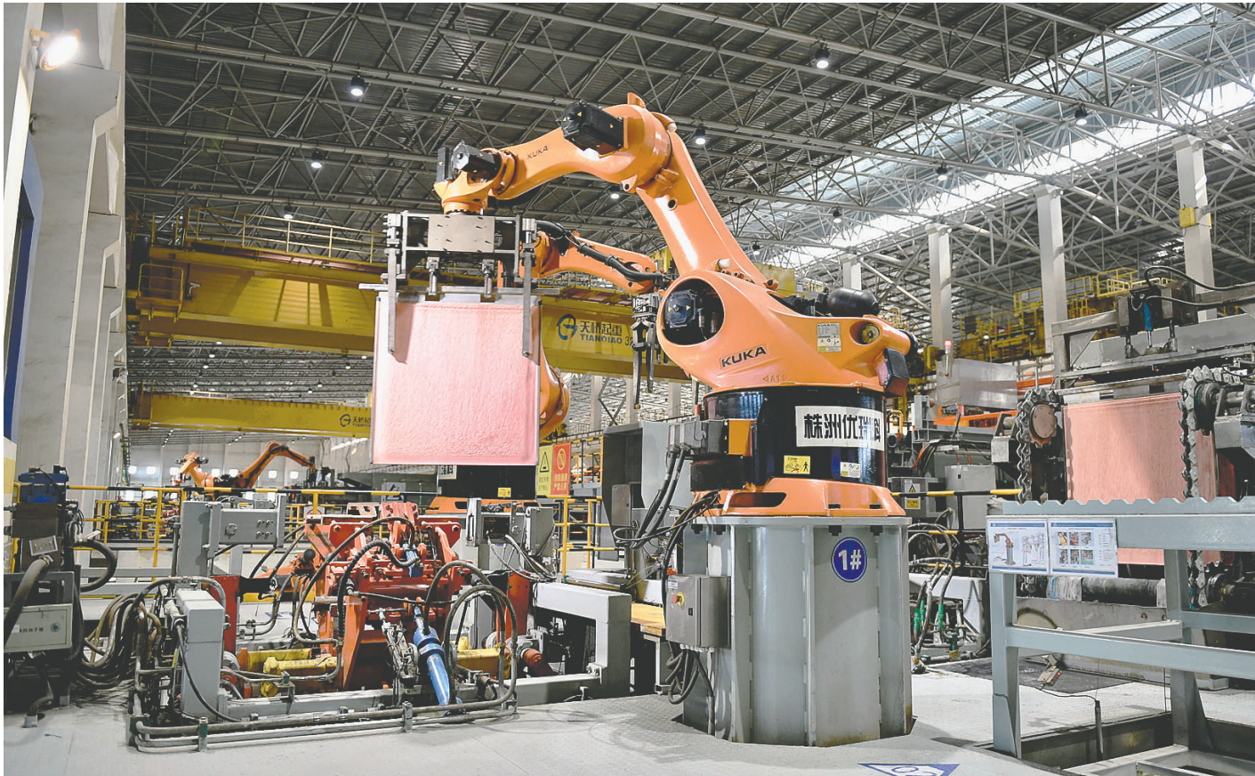
8月23日,在赤峰云铜有色金属有限公司电解车间内,机器人正在进行高纯阴极铜与永久不锈钢阴极板抓取分离。位于赤峰高新技术产业开发区东山产业园区的赤峰云铜有色金属有限公司,是国内唯一一家集烟气制酸、稀贵金属、烟尘综合回收利用在内的全流程铜冶炼生产企业,通过技术创新和研发,拥有金峰双侧吹熔炉、多枪顶吹连续吹炼炉等10余项国家专利。 本报记者 孟和朝鲁 摄
