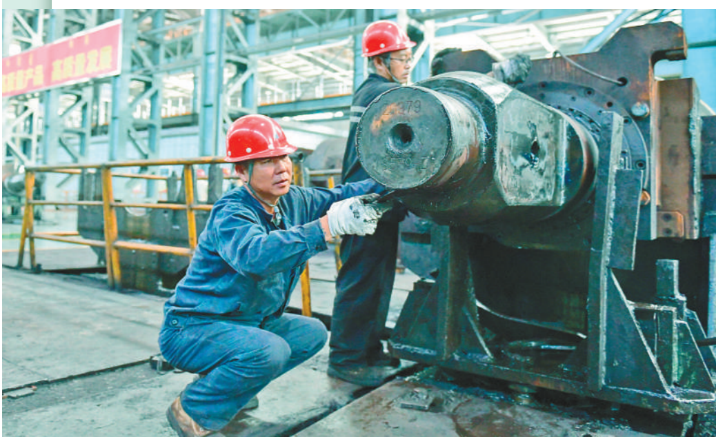
包钢轨梁厂职工正在装配维护轧辊,保证轧辊上线正常运转生产。据了解,全球海拔最高的青藏铁路,2/3的钢轨来自包钢。“长征”系列运载火箭、“神舟”号系列飞船、“中国探月工程”等国家重点工程中,也都有包钢稀土钢产品的身影。
