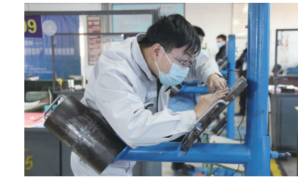
无损检测员纪书宁在超声波探伤实操比赛现场进行板对接焊缝检测
