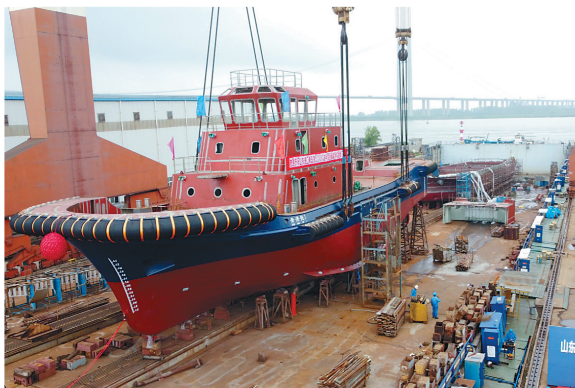
昨日，我国第一艘采用油电双驱动混合动力推进方式的3000吨全回转拖船“青港拖2”在镇江高新区顺利下水。该船是镇江船厂对多功能系列产品“大智”管智播播（视觉江苏供图）
