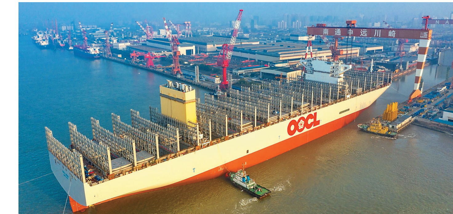
15日,一艘能装载2.4万个标准集装箱的超大型船舶在南通中远海运川崎船舶工程有限公司顺利下水。该船为这家公司系列订单的首制船,长399.99米、宽61.3米,甲板面积相当于3.5个标准足球场。彭常青 许从军 摄(视觉江苏网供图)
