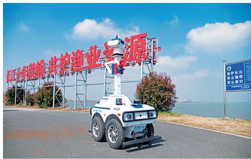
常州长江段能在以往执法人员难以巡查的地段进行自动巡航、灯光探测、喊话威慑的智能巡逻机器人
