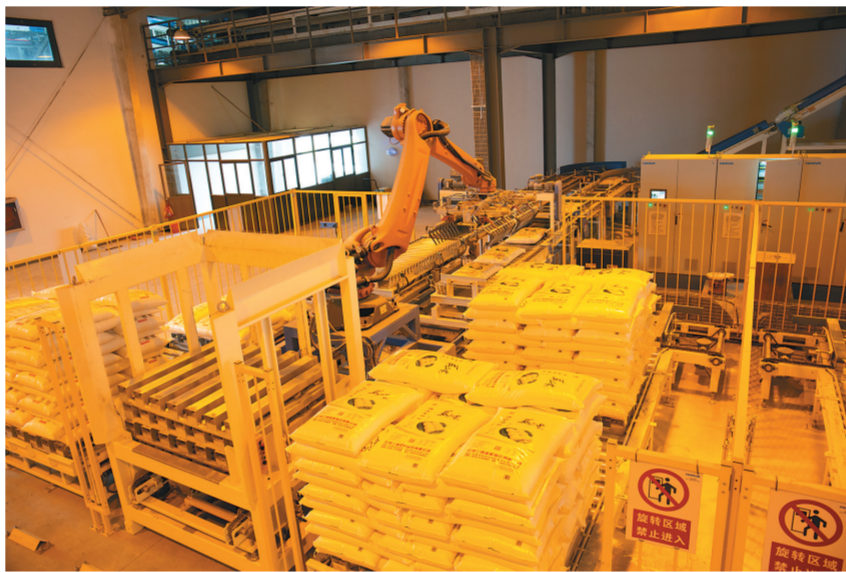
三零面粉有限公司面粉自动码垛现场
