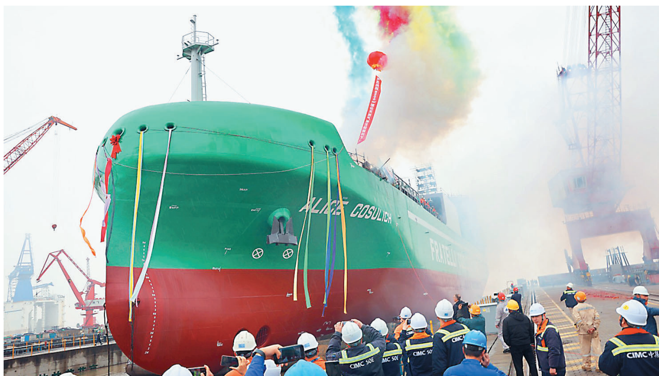
昨日,由中集太平洋洋工为意大利船东建造的8200立方米LNG加注船首制船(S1058)在启东海工船舶工业园下水。该系列船采用先进的电力推进方案,配备双燃料发电机组和高效全回转推进器,并具备完整的LNG加注功能,经济、节能、环保。 许从军 摄(视觉江苏网供图)
