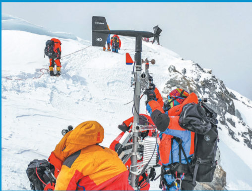
23日,科考登顶队员在珠峰海拔约8830米处维护升级自动气象站。
