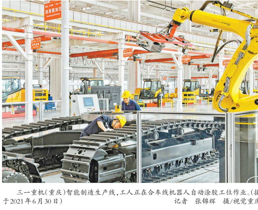
三一重机(重庆)智能制造生产线,工人正在合车线机器人自动涂胶工位作业。(摄于2021年6月30日) 记者 张锦辉 摄/视觉重庆
