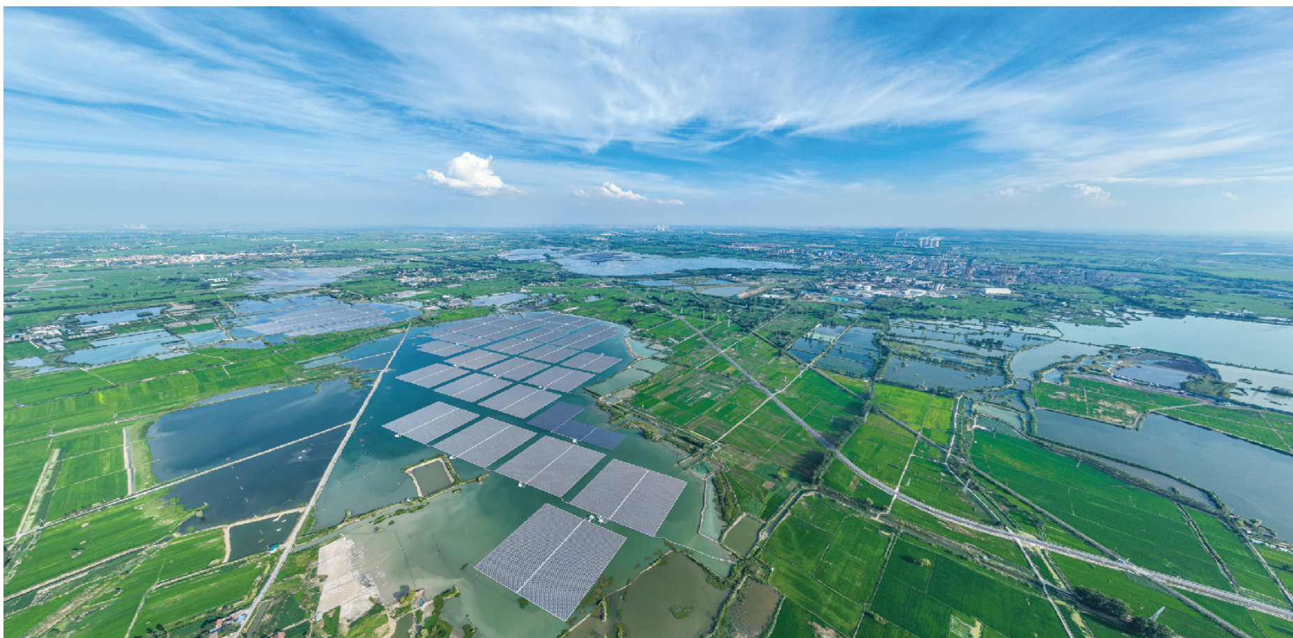
无人机拍摄全球最大水面漂浮光伏电站的全貌。该项目建造在淮南市潘集采煤沉陷区3000亩的水面上，总装机容量150兆瓦。
