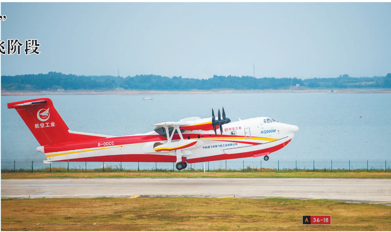
图为2022年9月27日，“鲲龙”AG600M从漳河机场滑行起飞。当日，由我国自主研发的大型水陆两栖飞机“鲲龙”AG600M，以全新红色消防涂装在湖北省荆门市漳河机场完成12吨投汲水试验。
