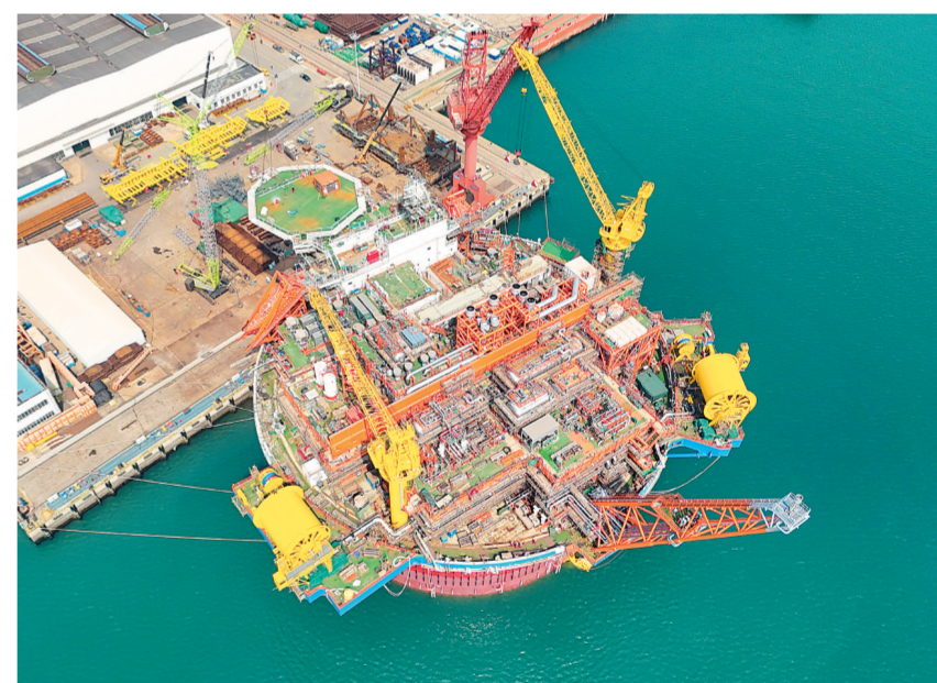
4月7日，由我国自主设计建造的亚洲首艘圆筒型“海上油气加工厂”——“海洋石油122”浮式生产储卸油装置(FPSO)，在海油工程青岛场地进行海上倾斜试验及调试。(新华社发)
