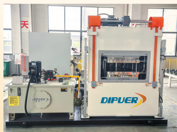
迪普实业新一代5G高频高速覆铜板层压机。(受访者供图)
