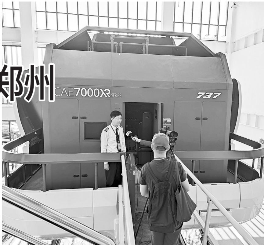
通过民航局CCAR-60部认证的D级全动模拟机 郑报全媒体记者 李丽君 摄
